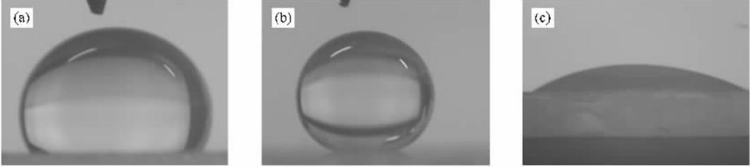
图 3 在(a)修饰后平滑 ZnO 薄膜(b)修饰后 ZnO 纳米棒薄膜以及(c)未修饰的 ZnO 纳米棒薄膜上的液滴形态
