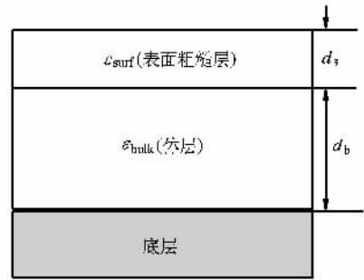
图 1 用于椭圆数据分析的两层光学模型
