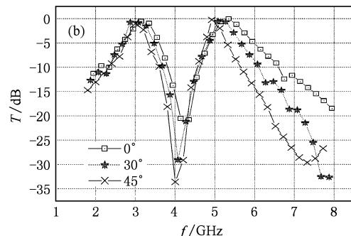
图 8 分形 FSS 传输特性测量结果 (a)60°栅格排布,(b)90°栅格排布
