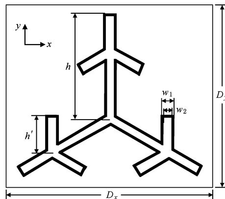
图2 二阶Y环结构参数示意图
