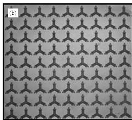
图 7 FSS 实验样件 (a)60°栅格,(b)90°栅格
