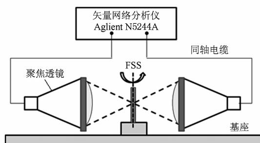
图 6 FSS 实验测量测试示意图
