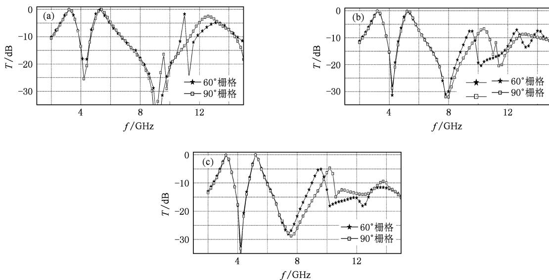
图5 不同排布方式下FSS的传输特性对比 (a)正入射,(b)30°入射,(c)45°入射
