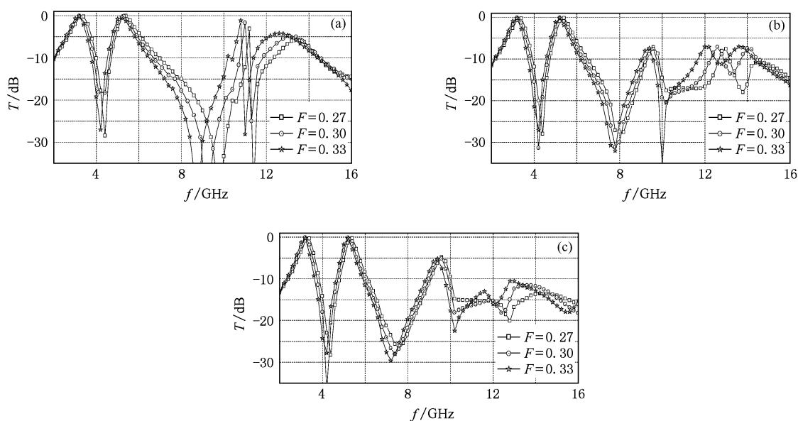
图 3  $F$  改变时 FSS 的传输特性对比 (a) 正入射, (b)  $30^\circ$  入射, (c)  $45^\circ$  入射
