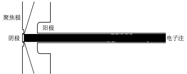
图 7 电子光学系统中电子注轨迹图
