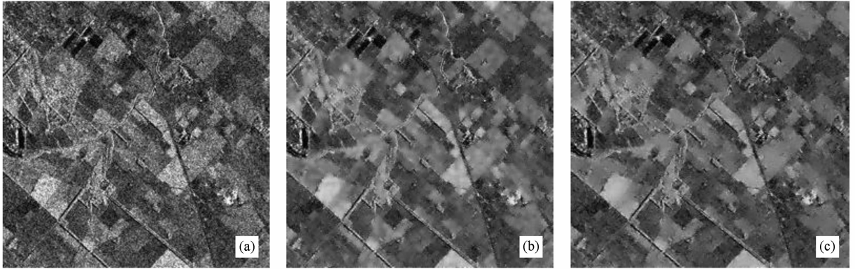
图4 自适应滑动窗的降斑结果 (a) SAR 图像; (b) 固定滑动窗的 Lee 滤波(滑动窗大小为 5); (c) 基于自适应滑动窗的 Lee 滤波(滑动窗最小为 3, 最大为 13, 平滑因子为 1)
