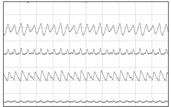
图 9 R = 40 \Omega , C_1 = 100 \mu F 时的实验波形 从上到下依次为 v_{veal} , R_{S1} i_L , v_{C1} 和 v_{C2} 的波形
