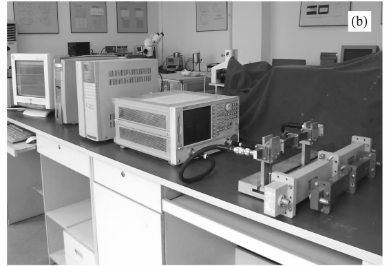
图 2 测试样品和测试系统 (a) 测试样品, (b) 波导测试系统
