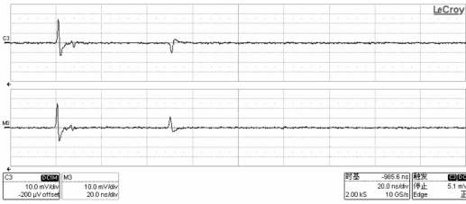
图 5 两根电缆中传输的尖峰噪声
