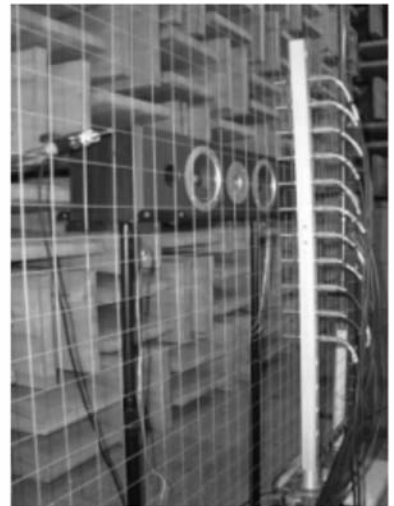
图 11 半消声室中近场声全息测量装置图
