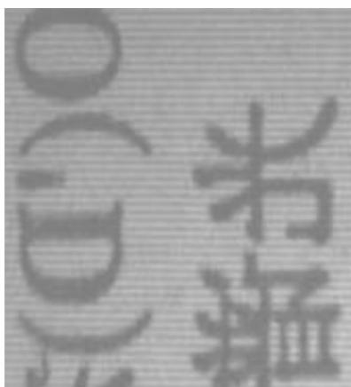
图 11 实验获得的视场补偿型 Savart 偏振干涉成像光谱仪干涉图
