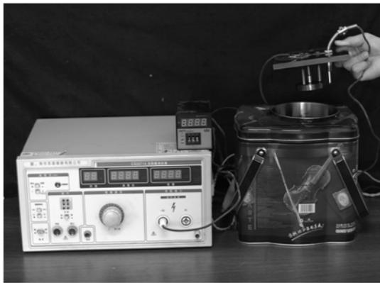
图 1 极化测试设备
