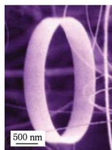
图 3 ZnO 纳米环的 SEM 图片
