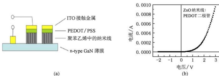
图 16 (a) ZnO 纳米线/聚合物 p-n 结示意图; (b) p-n 结的 I-V 曲线
