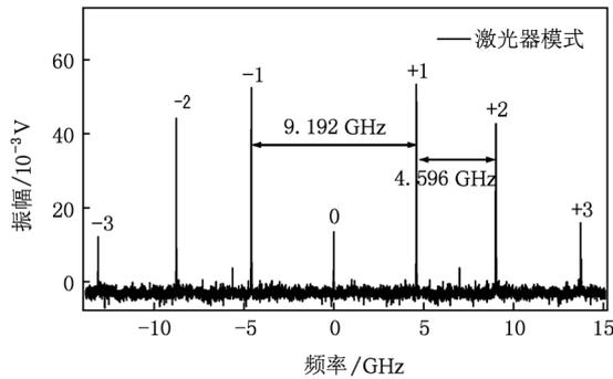
图5 射频调制频率为 4.596GHz 时激光器的输出模式
