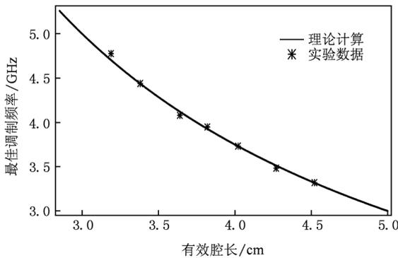
图2 有效腔长和最佳调制频率的关系
