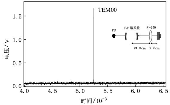
图3 无调制时激光器输出模式
