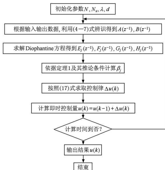
图 1 算法程序流程图
