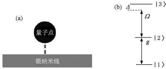
图1 (a) 杂化体系的结构示意图; (b) 半导体量子点能级结构图. |1\rangle, |2\rangle 和 |3\rangle 分别是量子点激子真空态、激子态和双激子态. 表面等离子体耦合 |1\rangle, |2\rangle 之间的跃迁, 经典光场耦合 |2\rangle, |3\rangle 之间的跃迁
