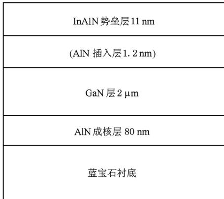
图1 InAlN/GaN 和 InAlN/AlN/GaN 材料样品结构示意图
