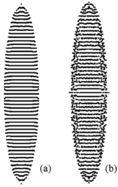
图1 0.01s时刻1961个粒子的分布情况 (a) KGC-SPH; (b) SPH
