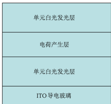
图10 叠层白光器件结构
