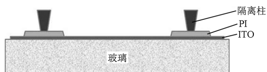
图 1 显示屏基片单个像素的侧面结构示意图
