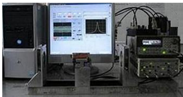
图9 层合结构磁电电压转换系数测试系统
