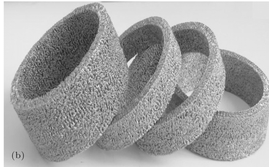
图 4 金属橡胶阻尼环 (a) 受力示意图; (b) 实物图片
