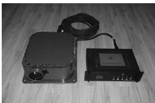
图1 舰船尾流激光雷达系统样机 左: 水下探测器; 右: 水上数据处理系统
