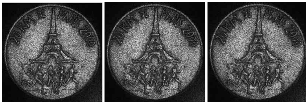
图 7 在焦深范围内 1-FFT 重建图像的比较 (360 × 360 像素) 左: z_m = 1420 mm (图像宽度 58.3412 mm), 中: z_m = z_i = 1500 mm (图像宽度 60.3529 mm), 右: z_m = 1580 mm (图像宽度 62.3547 mm)
