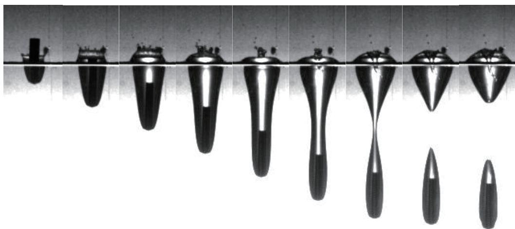
图 3 垂直入水空泡变化过程
