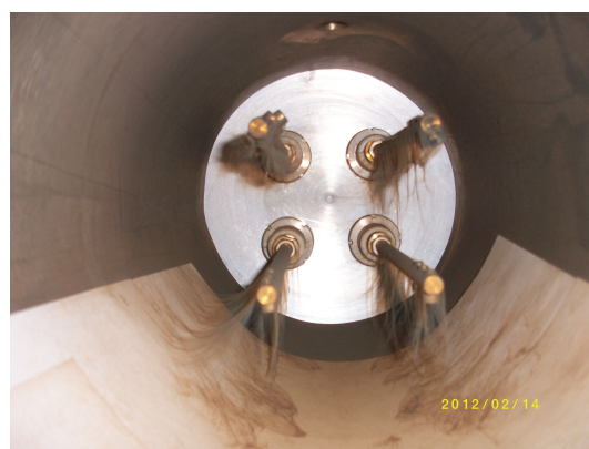
图 2 击穿后的铜丝形成的丝状物
