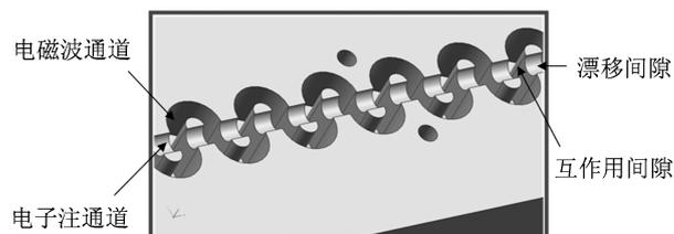
图 1 折叠波导行波管慢波线路
