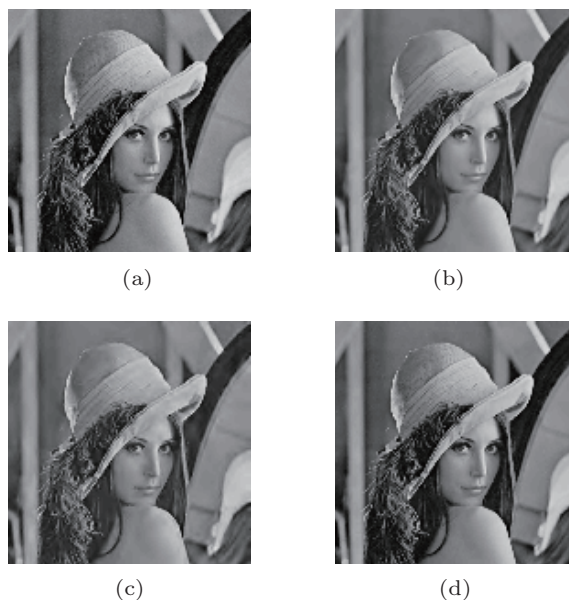
图 3 图像视觉质量比较 (a) 原始 Lena 图; (b) 只进行压缩的重构图像 (CR=0.250 bpp); (c) 重构图像加密与压缩关联 ( \delta = 1 , CR=0.250 bpp); (d) 重构图像加密与压缩关联 ( \delta = 512 , CR=1.000 bpp)
