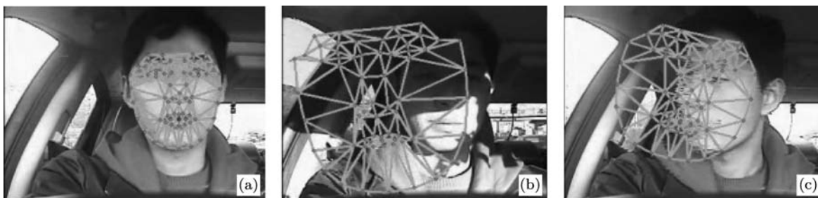
图4 ASM算法的检测结果 (a) 光照均匀、正面姿态下实验结果; (b) 光照不均匀下实验结果; (c) 姿态偏转下实验结果
