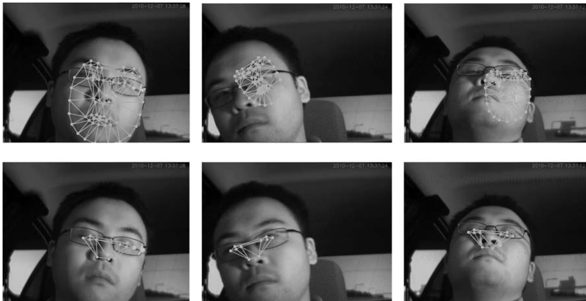
图 10 68 点 ASM 算法与 10 点 ASM 算法检测结果比较
