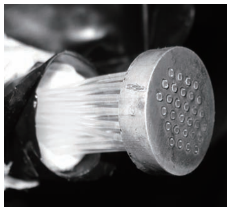
图 4 30 根波移光纤固定在金属块上
