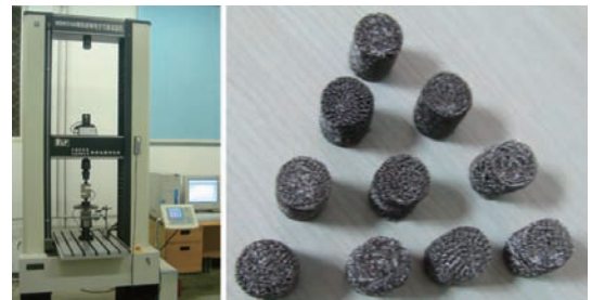
图 10 金属橡胶构件的测试系统和样件
