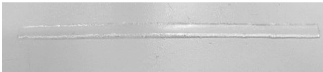
图 6 100^{\circ}\text{C} 时置于温控箱中间, 先固化 5 min, 前后位置调换后, 再固化 5 min 后所制备的波导实物图
