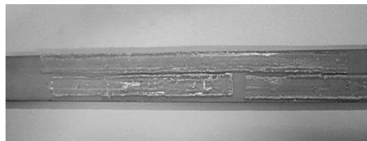
图 5 固化时间过长和固化温度过高时所制备的波导实物图
