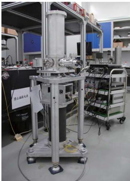
图 6 T-1 型绝对重力仪在清华大学精密测量联合实验室
