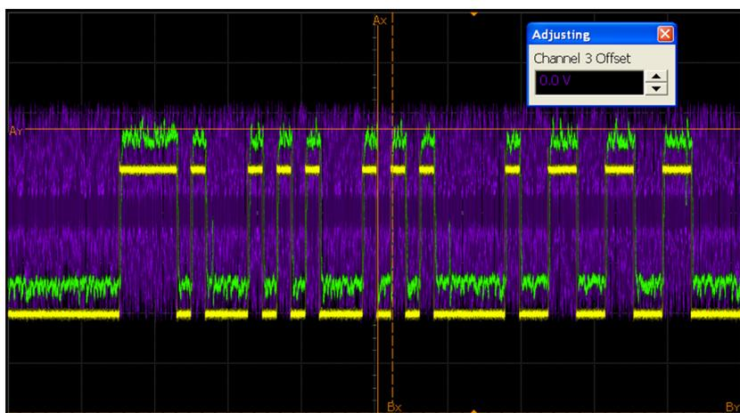
图 12 解调 Sine 混沌映射示波器显示结果
