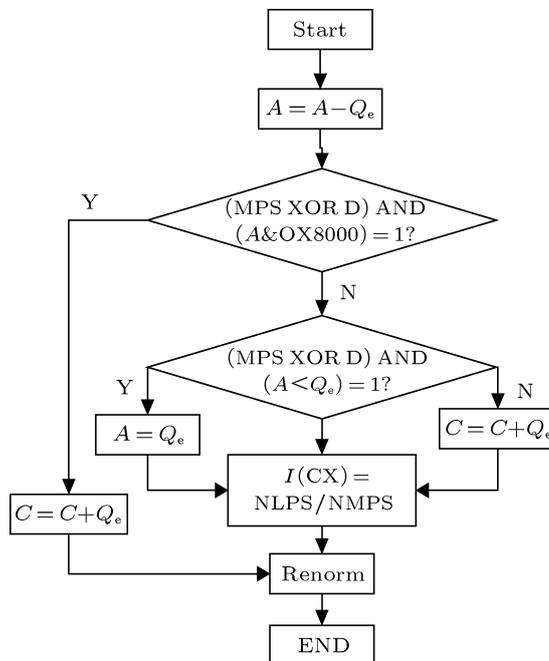
图 3 MQ 编码器算法流程图
