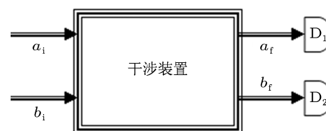
图 2 四端干涉装置示意图. 输入输出各两个端口, 中间相互作用环节可以建立与装置相关参数有关的输入输出关系
