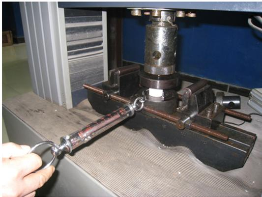
图9 摩擦系数测定
