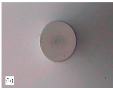
图5 实验制备的少模光纤 (a) 折射率分布; (b) 实物横截面图
