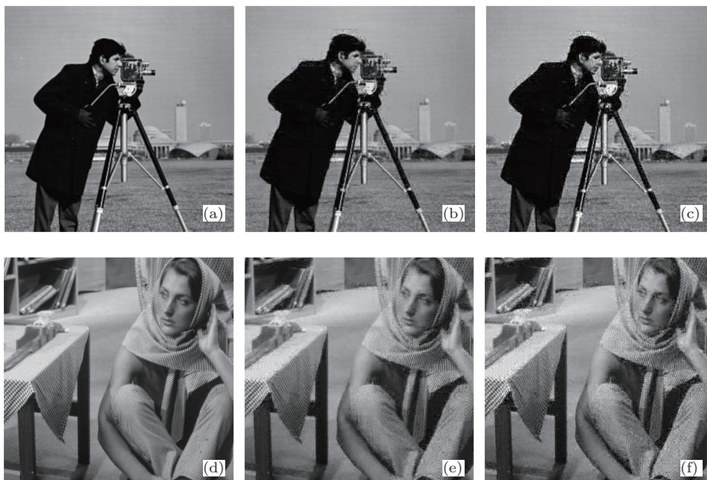
图 3 采样率  $M/N = 0.5$ , cameraman, barbara 重建结果 (a), (d) 原始图像; (b), (e) 本文算法; (c), (f) OMP 算法
