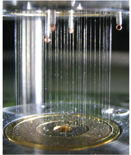
图 2 第 12141 发次双层丝阵 (内层 21 根丝、外层 42 根丝) 及磁探针照片
