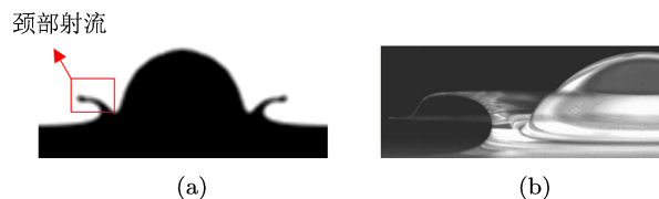
图5 颈部射流 (a) 计算结果; (b) Thoroddsen [23] 实验结果
