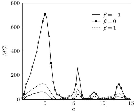
图 10 不同  $\beta$  作用下  $MG$  随系统参数  $a$  的演变规律曲线 ( $b = 0.126, \alpha = 1.2$ , 高频)
