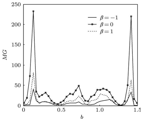
图 11 不同  $\beta$  作用下  $MG$  随系统参数  $b$  的演变规律曲线 ( $a = 5.8, \alpha = 1.2$ , 高频)
