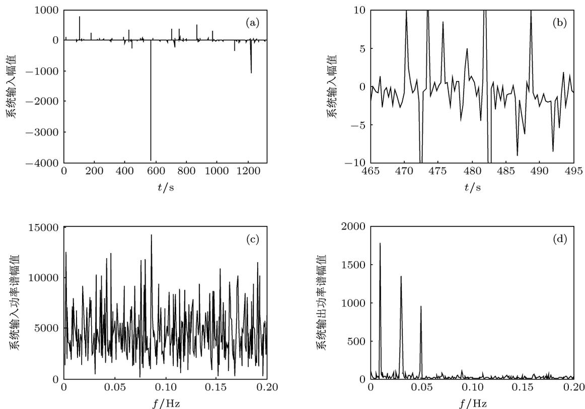
图2 (a) 系统输入时域图; (b) 系统输入时域图的局部放大图; (c) 系统输入功率谱图; (d) 系统输出功率谱图 (多个低频信号)
