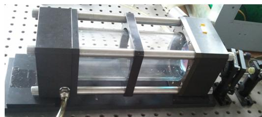
图 2 多次反射池的整体结构图
