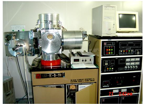
图 1 考夫曼型离子束刻蚀机照片
