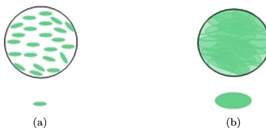
图 3 散斑在 CCD 上成的像 (a) 焦平面处散斑在 CCD 上成的像; (b) 焦平面外散斑在 CCD 上成的像
