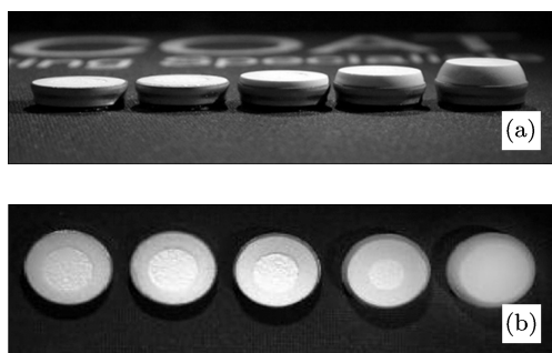
图 5 利用飞秒激光切割的半球型雷管 (a) 雷管侧面图; (b) 雷管俯视图
