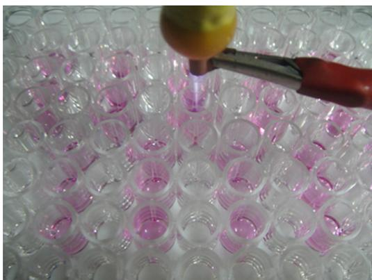
图 2 大气压冷等离子体射流处理 HeLa 癌细胞的实物图
