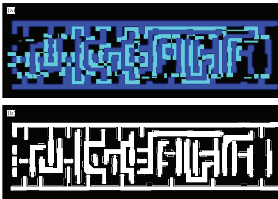
图 7 (网刊彩色) 实际版图的短路关键面积和开路关键面积 (a) 版图的短路关键面积; (b) 版图的开路关键面积
