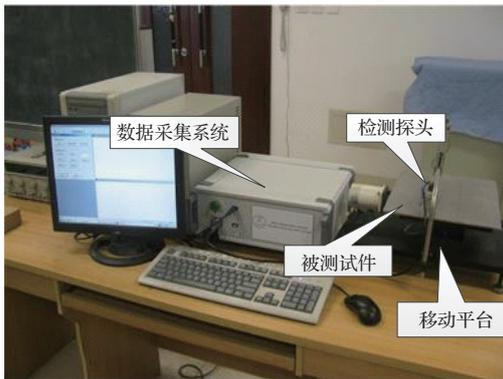
图1 电涡流检测系统实验装置及检测平台
