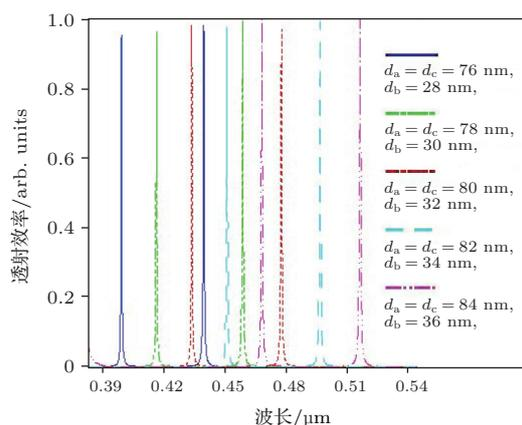
图5 (网刊彩色) 介质层厚度对透射谱的影响
