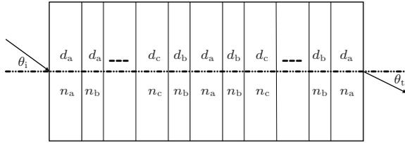
图 1 一维对称双缺陷光子晶体结构
