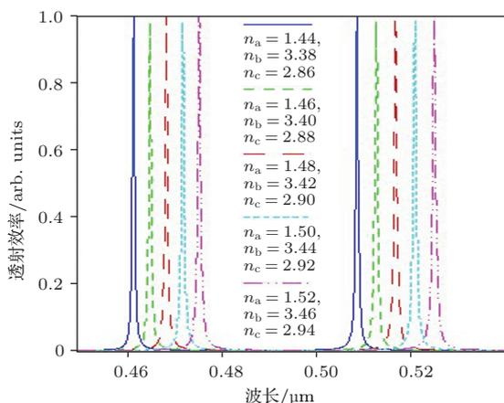
图4 (网刊彩色) 介质层折射率对透射谱的影响
