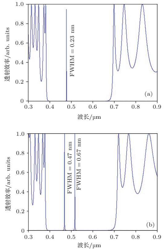
图2 单缺陷(a)、对称双缺陷(b)一维光子晶体透射谱
