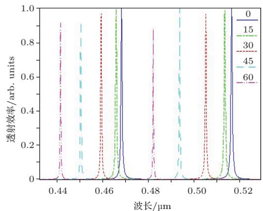
图3 (网刊彩色) 入射光角度对透射谱的影响
