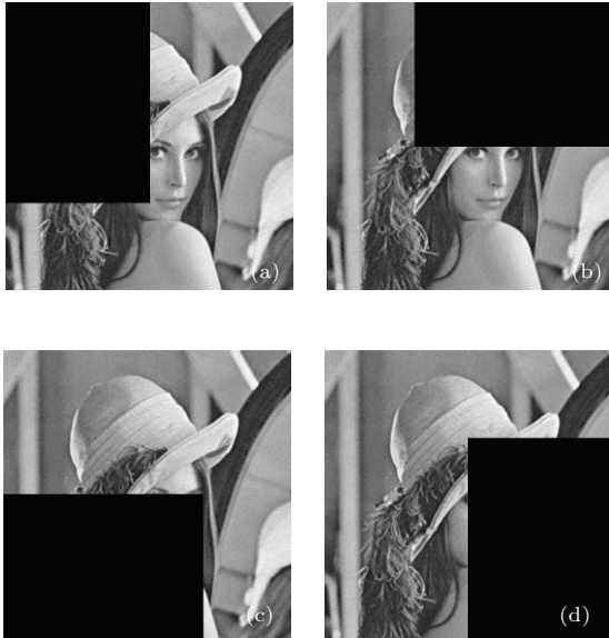
图11 带有50像素偏移的照明方式 (a) 第一次照明 P_1 ; (b) 第二次照明 P_2 ; (c) 第三次照明 P_3 ; (d) 第四次照明 P_4
