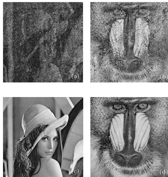
图7 经100次迭代获得的重建复振幅 (a) 无相位调制器时, 重建的振幅; (b) 无相位调制器时, 重建的相位; (c) 有相位调制器时, 重建的振幅; (d) 有相位调制器, 重建的振幅
